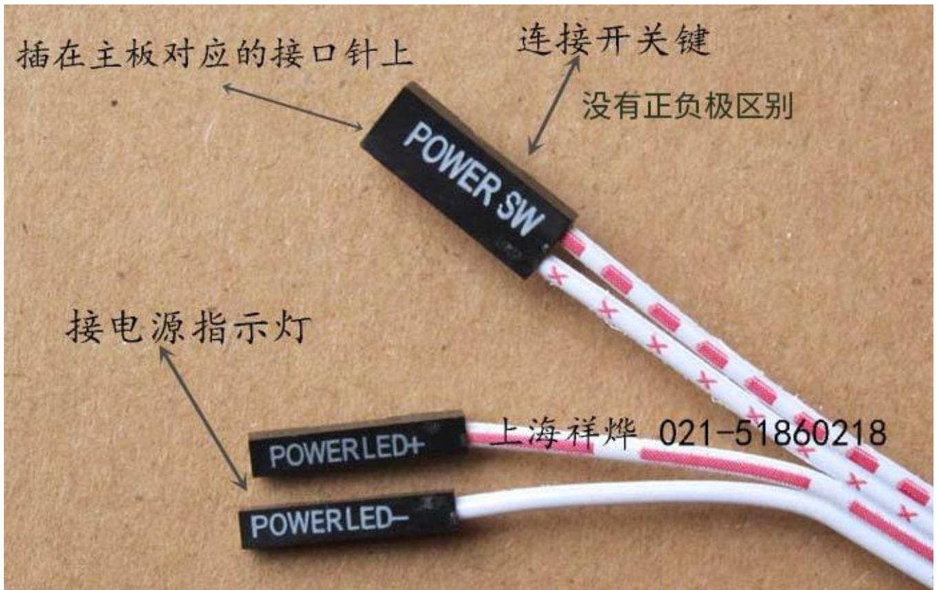
3.电源灯(POWER LED) 开关连线的插头 POWER LED 字样，主板上对应位置的插针附近的英文缩写一般为 PW LED、Power LED、PWR LED 或 PLED + 和 PLED-等。LED+是正极线，LED-为负极线。
