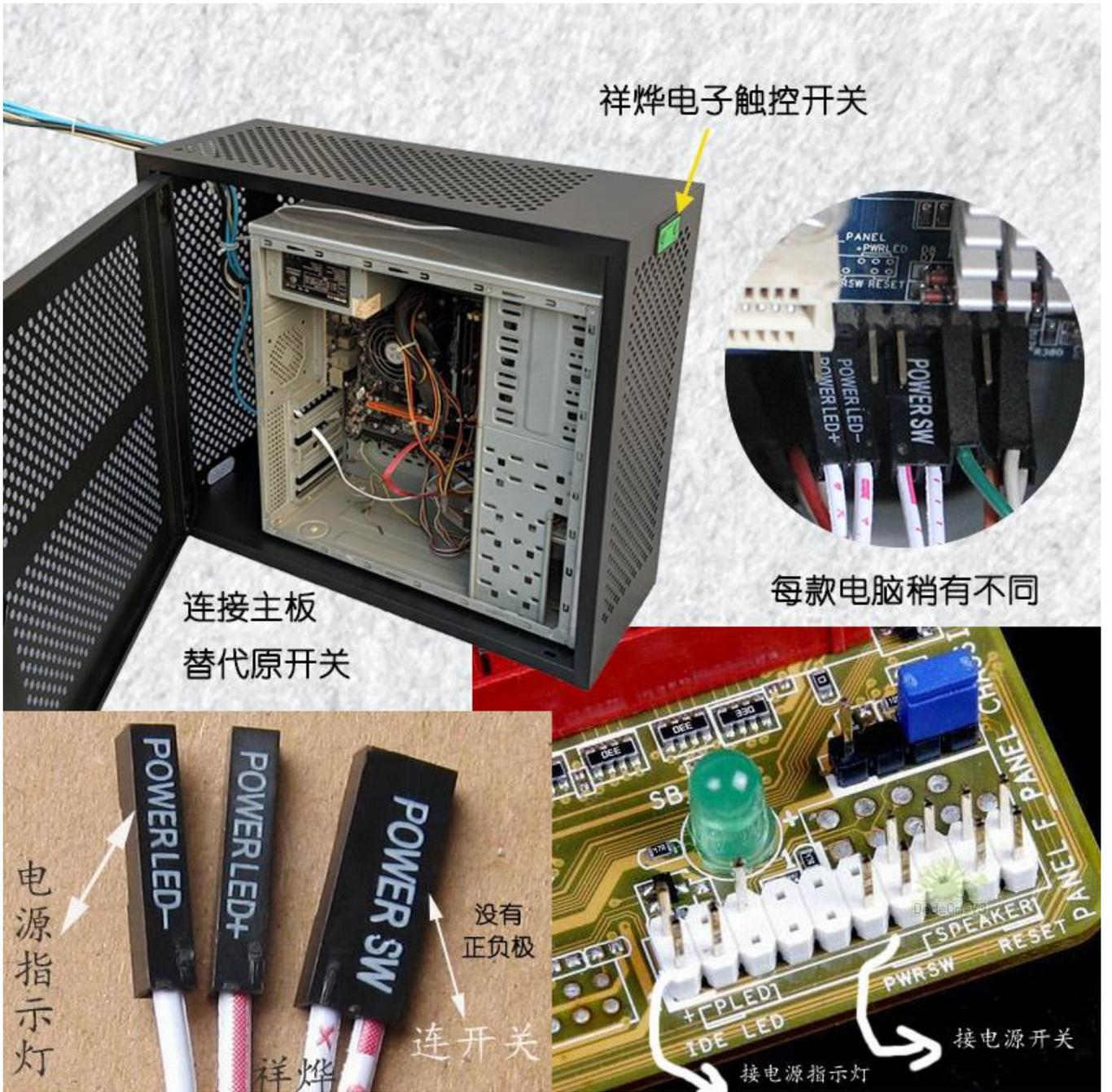
原开关线拔掉，这个接头插到对应位置。
